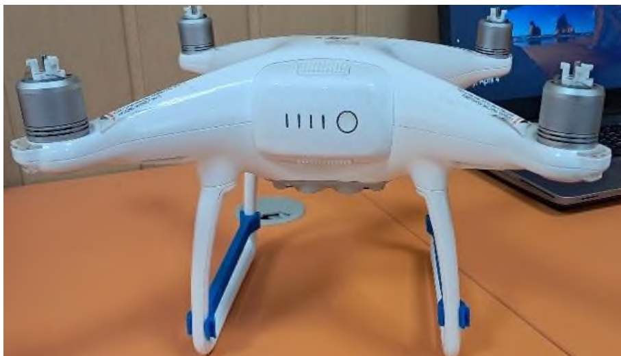
Рис. 1. Дрон моделі DJI Phantom 4 з підготовкою шасі до монтажу моніторингового блока
