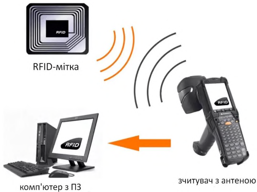
Рис. 1. Схематичне зображення складових RFID та їх взаємодія
