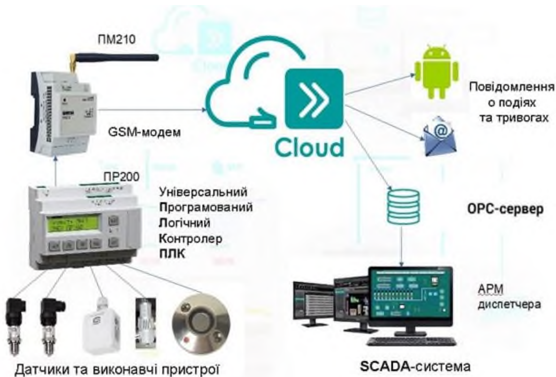
Рис. 1 – Система диспетчеризації на базі промислових ПЛК та «хмарного» середовища
