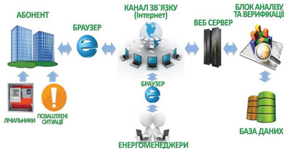
Рис. 2. Схема роботи енергомоніторингу у місті Миколаїв.
