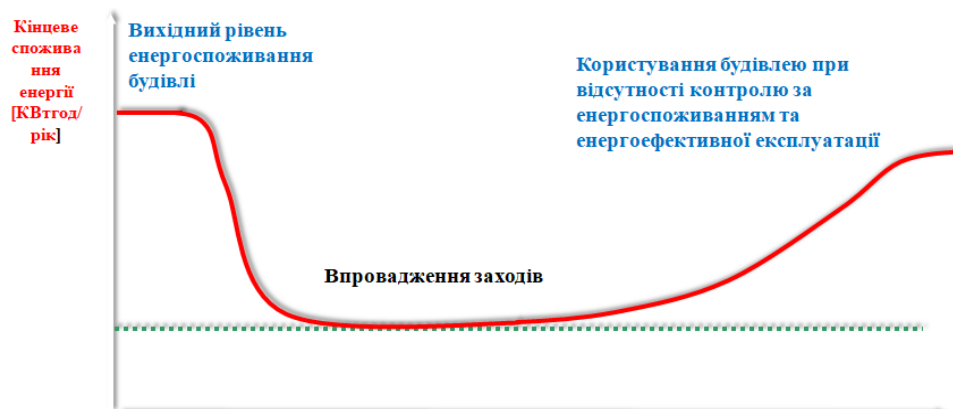
Рис. 1. Цикл впровадження енергоефективних заходів в умовах неконтрольованої поведінки користувачів і відсутності культури експлуатації енергосистем
